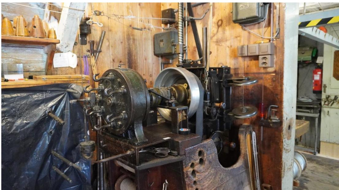
Das dünnste Seil ist gerade 0,4 mm und das dickste 10 cm im Durchmesser. Da die Seile nach alter Tradition hergestellt und konfektioniert werden, ist es möglich Kleinstmengen oder Sonderanfertigungen herzustellen. Aber auch grosse Mengen können in kürzester Zeit hergestellt werden.
